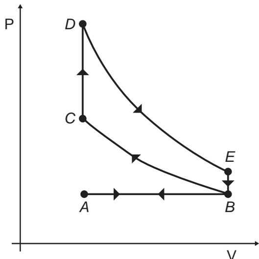
Para o motor descrito, em qual ponto do ciclo é produzida a centelha elétrica?
